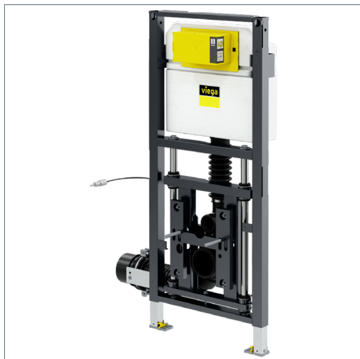
Obr. 145: WC prvek Prevista Dry, výška keramiky individuálně nastavitelná uživatelem stisknutím tlačítka (model 8521.32)
