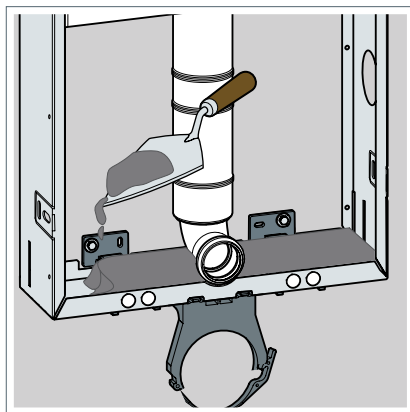
Obr. 50: Vyplňte spodní část WC bloku maltou.
