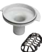
svislý model součástí vybavy není: zápachový uzávěr odtokový výkon při výšce vodní hladiny 10 mm 1,2 l/s odtokový výkon při výšce vodní hladiny 20 mm 1,2 l/s model 4982.83
