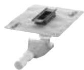
Model: 4981.80 Standardní odtokové těleso Výška: 95–155 mm Výška vodní uzávěry: 50 mm Odtokový výkon: 0,5–0,75 l/s*
