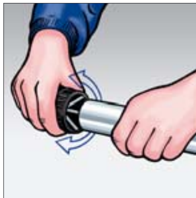
2. Odhrotujte vnitřní a vnější strany trubky.
