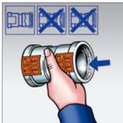
5. Zkontrolujte správné dosednutí těsnícho prvku a řezného kroužku.
