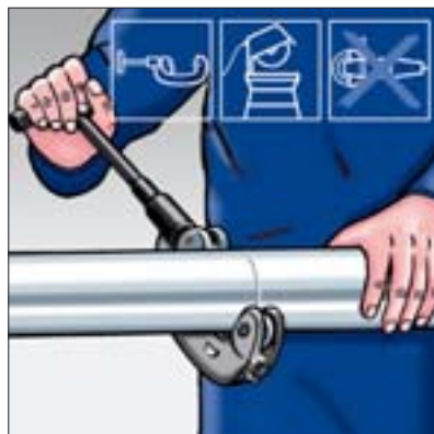
1. Kolmým řezem zkratíte trubku.
