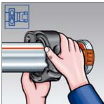
7. Nasadte lisovací prstenec na spojku a zkontrolujte správnou polohu.
