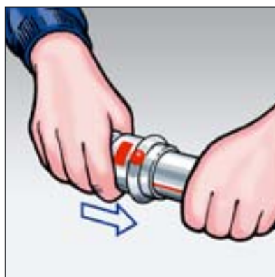
4. Nasuňte lisovací spojku na trubku až na doraz.
