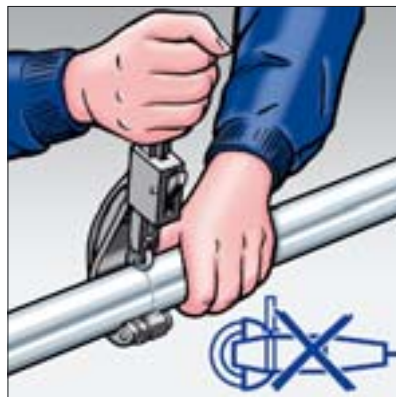
1. Kolmým řezem zkratíte trubku.
