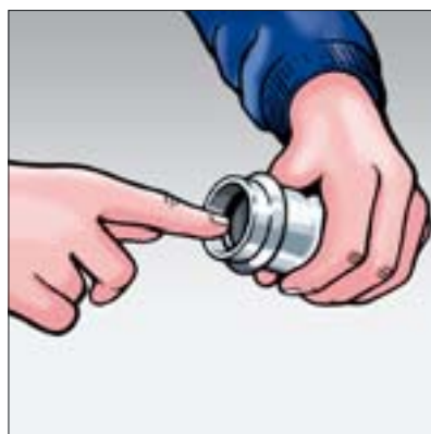
3. Zkontrolujte správné dosednutí těsnícího prvku.
