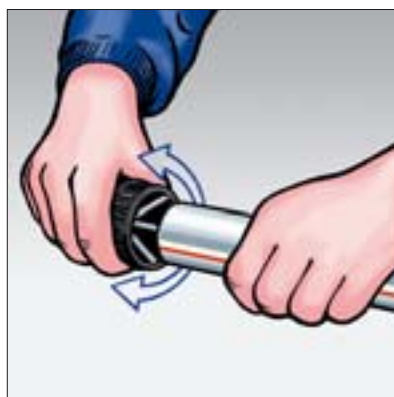
2. Odhrotujte vnitřní a vnější strany trubky.
