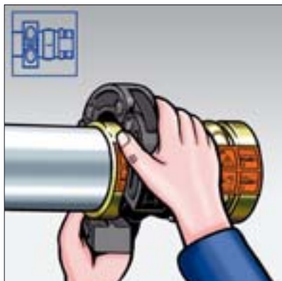
7. Nasadte lisovací řetěz na spojku a zkontrolujte správnou polohu.
