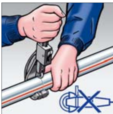
1. Kolmým řezem zkratíte trubku.
