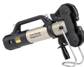
Inovativní nástavec Press Booster k nástroji Pressgun pro zajištění dostatečné síly lisu u Megapress S XL, s integrovanou kloubovou tažnou čelistí pro rozměry 2½, 3 a 4 palce.
