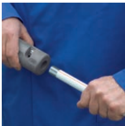
Nástroj firmy Viega na odpláštění bílého vnějšího pláště trubek Prestabo.
