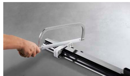
Tělo žlábků jde během chvilky zkrátit pilkou využitím pomůcky pro zkrácení.
