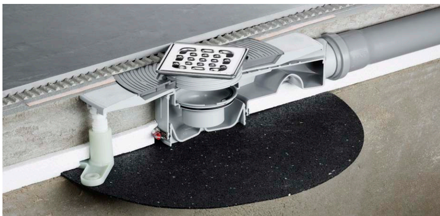
Odtok Advantix Top bezpečný proti zpětnému vzduťi díky vodní uzávěře s průtočným otvorem uprostřed a záchytnými komorami na stranách.
